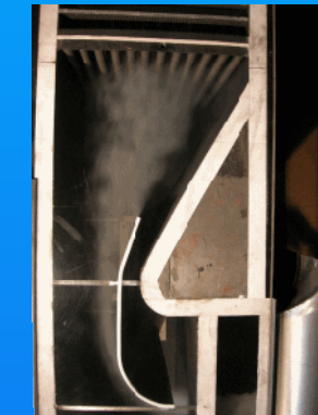
mit Leitblech Nebel oberhalb
